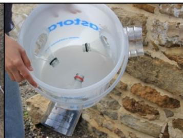
Coller les bouteilles à l'intérieur de tel sorte qu'elles ne soient pas orientées en face des autres.
